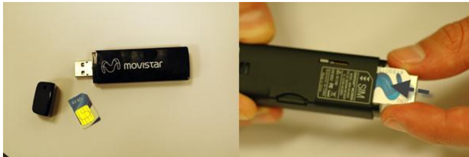
Figura 1. Ejemplo de cómo insertar la tarjeta SIM en un Dispositivo Internet Móvil.
